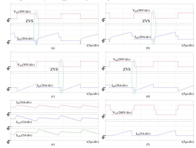
Simulation waveforms of main switches, clamped switches, coupled inductor, and rectifying diode at  $P_o = 2kW$ . (a)  $Q_1$ ; (b)  $Q_2$ ; (c)  $Q_3$ ; (d)  $Q_4$ ; (e)  $I_{in}$  and  $L_r$ ; (f)  $D_1$ .
